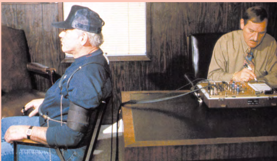
В полиграфе манжета на руке измеряет давление крови и частоту сердечбиений, пневмограф вокруг грудной клетки измеряет частоту дыхания, а электроды на пальцах замеряют КГР. Регистратор справа показывает физиологические реакции испытуемого, когда он лжет и когда имитирует ложь.
